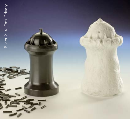
Bild 2: Bauteil vor und nach Veranschung.
